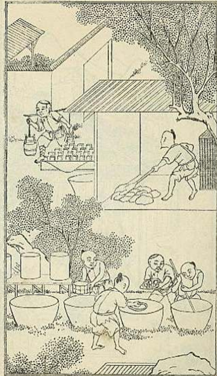
On lave et l'on épure la terre molle de kaolin. Partie supérieure.— Un homme mélange de la terre et de l'eau; un autre homme pétrit la terre. Partie inférieure.— Le lavage, le tamisage de la terre et le séchage.
